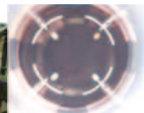
フィードバックキッカーの内部 対向する4つの電極からの電磁波でビームを水平鉛直にキックします。
