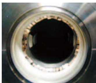
破壊された真空機器(ペローズ)
